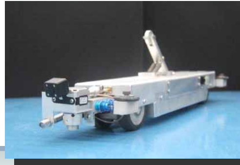
四川大学参赛作品 《电缆管道机器人嵌入式测 控系统的设计与实现》
