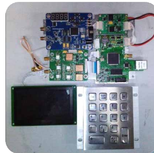
重庆大学参赛作品 《基于FPGA的超高频局放检测系统》
